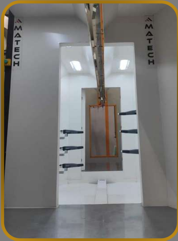
MATECH , PLC-gesteuerte Lackierzentrumsausrüstung der Marke Matech: Es ist ein ergänzendes Element von Lacksystemen zur Verbesserung der Lackqualität und eines schnellen Farbwechsels
